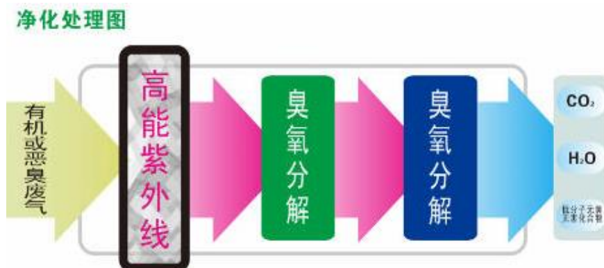
图 8.2-1 UV 光氧处理工艺流程
